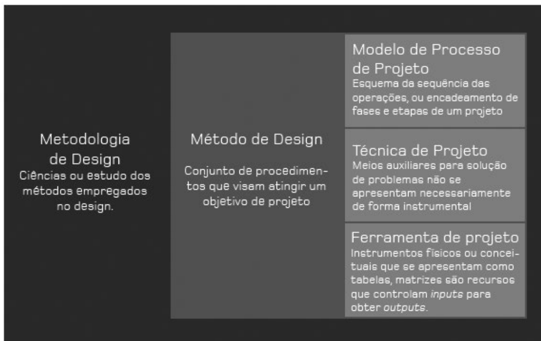
Figura 2: Diferenciação de termos: Metodologia, Método, Modelo, Técnica e Ferramenta (Fonte: PAZMINO, 2015, p. 12)
