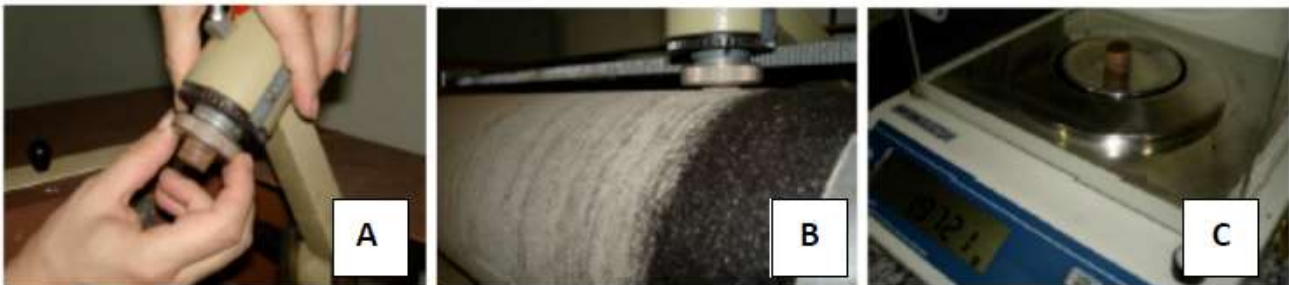
Figura 4 --- Corpo de prova a ser ensaiado (A); corpo de prova ao final do ensaio (B) e corpo de prova pesado ao final do ensaio (C)
