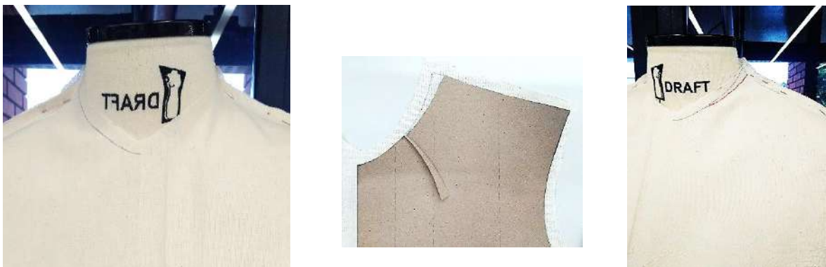
Fig. 98: Decote da base de blusa: a) sem folga; b) molde com folga de 1cm; c) no tecido com folga de 1 cm. Fonte: Acervo pessoal.
