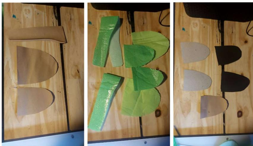
Figura 53 - Etapas de modelagem e corte das peças do calçado
