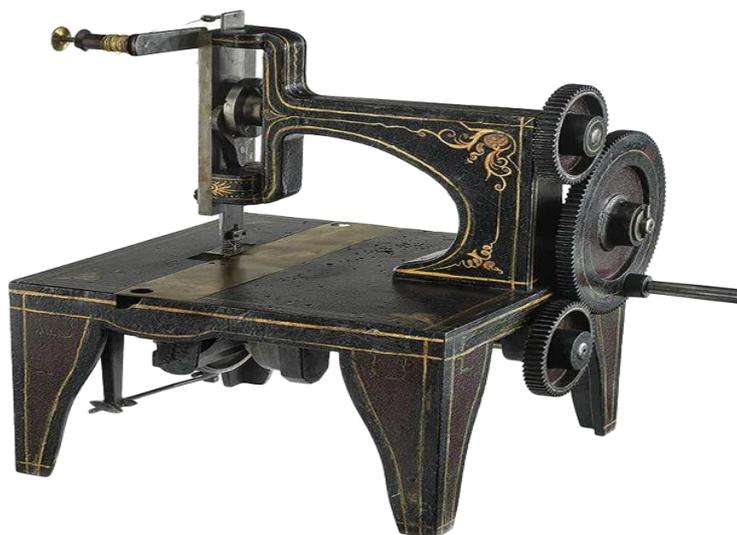
Figura 09 – 1851 - Máquina de costura prática desenvolvida por Isaac Merritt Singer, com agulha reta e orifício na ponta.
