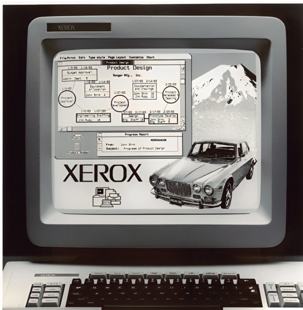
Figura 5: sistema Xerox Star demonstrando elementos do que hoje conhecemos como interfaces gráficas com o usuário (em inglês, GUI - Graphical User Interfaces ).
